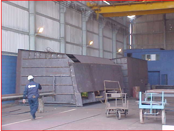
FABRICACION MODULOS BODEGAS EN TALLERES
