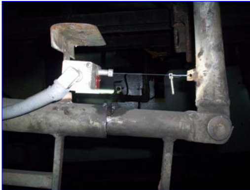
Sensor controlando el avance de las palanquillas. A la izquierda: posición inicial de la viga móvil. A la derecha: posición final de la viga móvil.
