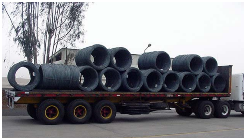
Nuevo sistema de apilamiento de rollos soldados en el camión
